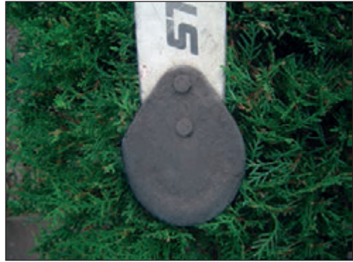
Foto 71. Prototipo Forex para puntero de motosierra en emergencias.
