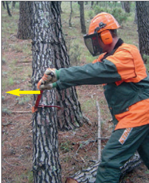
Foto 160. Volteado con palanca.
