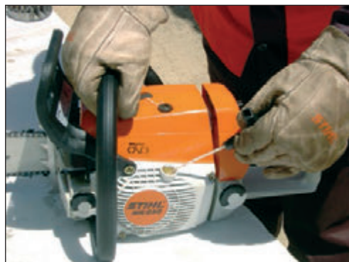
Foto 102. Comprobación del tiraflector
