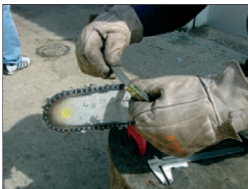
Foto 88. Rebaje de talones o limitador de corte.
