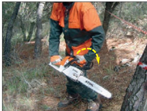
Foto 82. Activación del freno de cadena a golpe de muñeca
