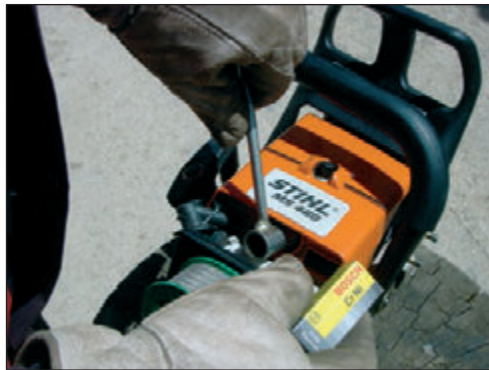
Foto 110. Sustitución de la bujía.
