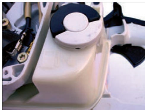
Foto 15. Depósito de combustible, tapón de apertura rápida.
