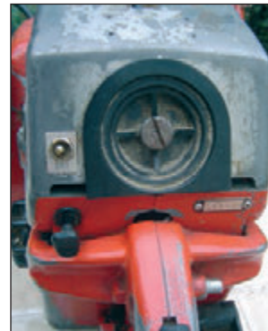
Foto 50. 1. Sistemas de control. a) Interruptor on/off. b) Sistema de arranque en frío.
