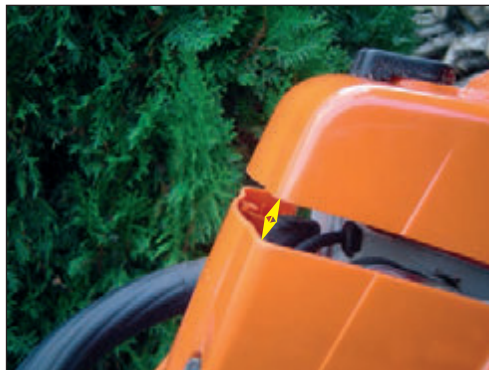
Foto 42.1. Comprobación del estado de la amortiguación.
