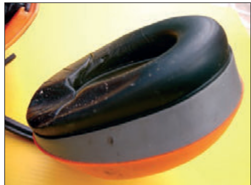
Foto 145-1. Auricular deformado por mal almacenamiento.
