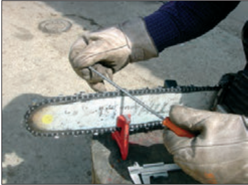
Foto 85. Afilado a mano alzada
