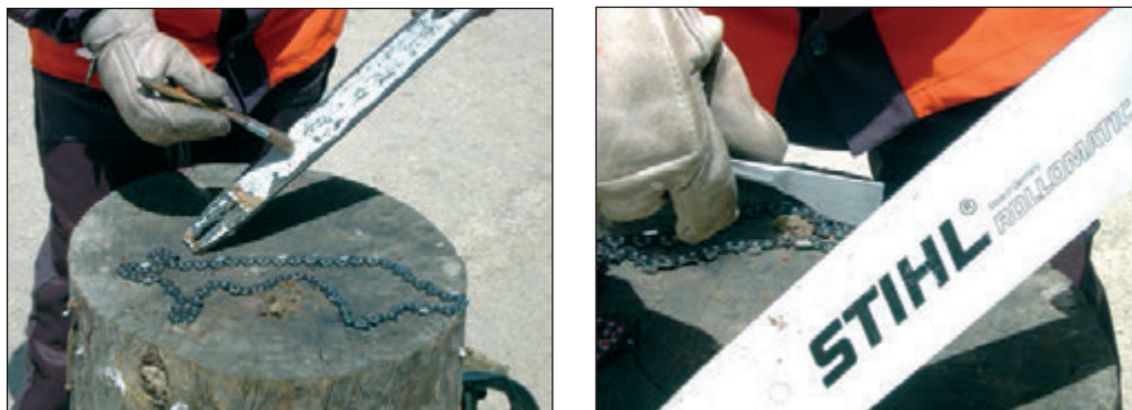
Foto 93-94: La limpieza garantiza un mejor engrase y el cambio de posición un desgaste uniforme, propiciado una vida útil más larga de la misma. Al igual el que engrase del piñón de reenvío para aquellos modelos que lo precisan.
