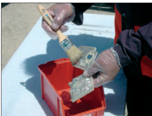
Foto 89. Limpieza del filtro de aire, con gasolina sin aceite
