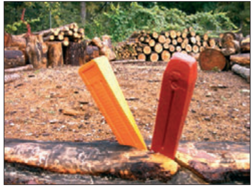
Foto 159. Cuñas de apoyo al derribo
