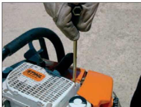
Foto 95: Reapriete de tornillos
