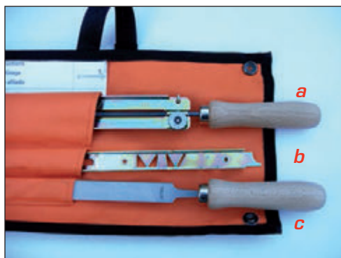
Fotos 113. Estuche de afilado. a) Portalina. b) Plantilla. c) Lima Plana
