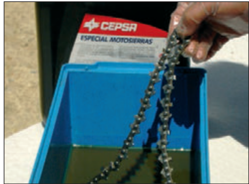
Foto 90-91: El afilado con filijonte es una garantía de buen mantenimiento de la cadena especialmente para el operador sin experiencia, así como para corregir desperfectos del diente de corte en todo momento. La cadena debe ser sustituida a diario por la de repuesto al finalizar la jornada de trabajo, o antes, si sufre desperfectos importantes, consiguiendo con ésta práctica un mejor aprovechamiento del juego de cadenas y el piñón de arrastre.
