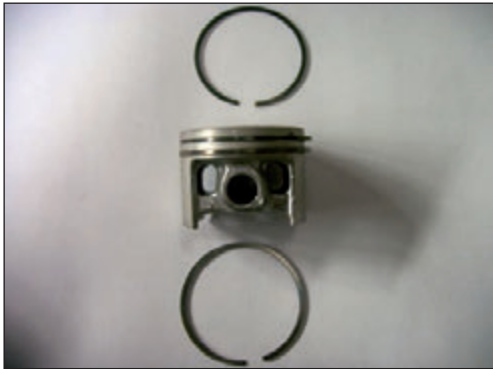
Foto 6. Cilindro con segmentos montados y segmentos desmontados
