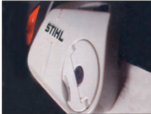
Foto 59. Fuente: Catálogo Stihl 2005. Tensado rápido de cadena.
