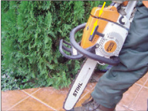
Foto 41. Comprobación del estado de la amortiguación.
