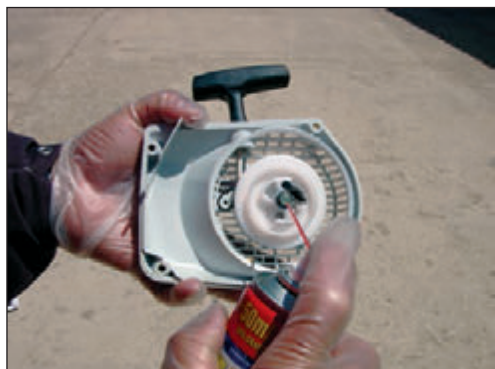
Foto 101. Engrase del dispositivo de arranque
