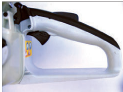
Foto 49. Mango o empuñadura trasera, bloqueador del gatillo de aceleración, gatillo de aceleración.
