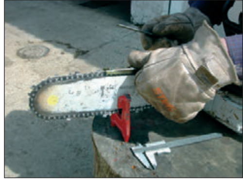
Foto 86. Comprobación del talón con plantilla
