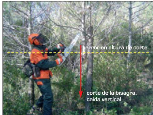
Foto 194. Error en la altura y técnica de corte. (Caída vertical del tronco).
