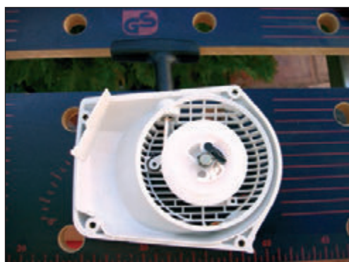
Foto 30. Tiraflector, cuerda, polea y rejilla de ventilación.
