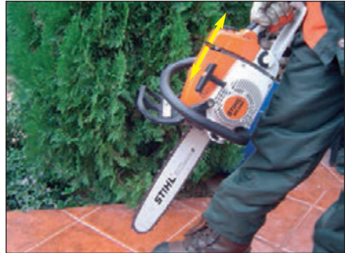
Foto 42. Comprobación del estado de la amortiguación.
