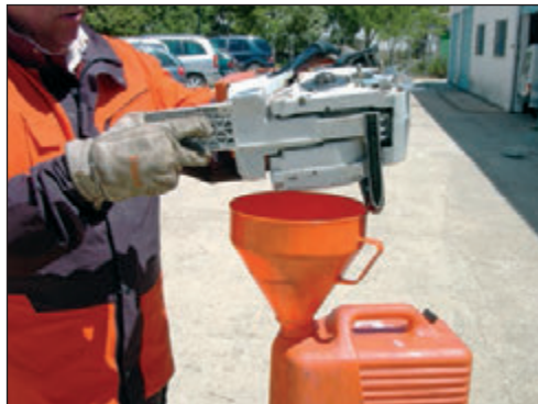
Foto 107. Vaciado de depósitos.
