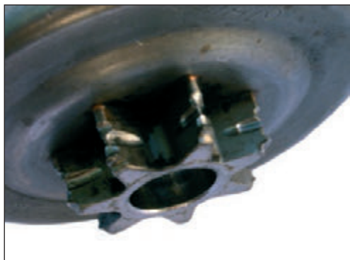
Foto 35. Piñón tipo estrella con claros signos de desgaste.
