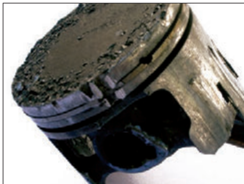
Foto 8. Pistón dañado por falta de aceite 2T (Gripado).
