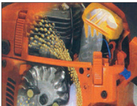
Foto 29. Sistema de ventilación y alimentación forzada. Fuente: Catálogo Inter Forst.
