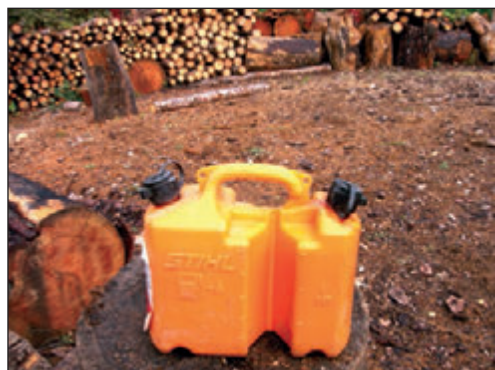
Foto 162. Bidón combinado: aceite de engrase del órgano de corte y mezcla aceite 2T - gasolina.
