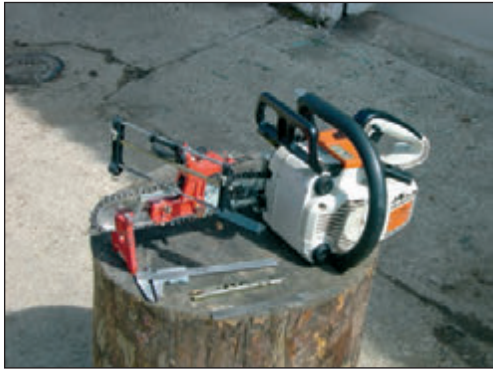
Foto 90-91: El afilado con filijonte es una garantía de buen mantenimiento de la cadena especialmente para el operador sin experiencia, así como para corregir desperfectos del diente de corte en todo momento. La cadena debe ser sustituida a diario por la de repuesto al finalizar la jornada de trabajo, o antes, si sufre desperfectos importantes, consiguiendo con ésta práctica un mejor aprovechamiento del juego de cadenas y el piñón de arrastre.
