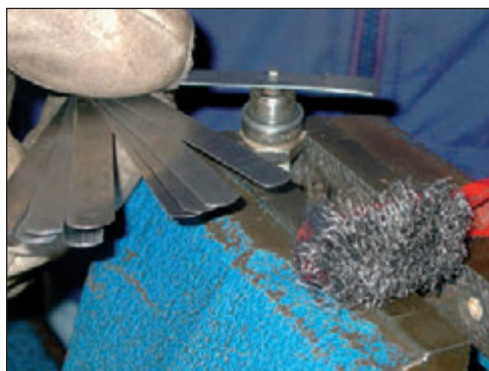
Foto 99. Calibrado de Bujía
