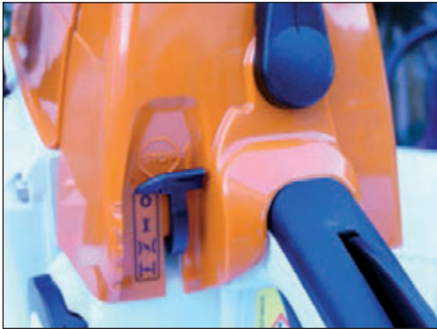
Foto 50. Palanca de control maestro o encendido.
