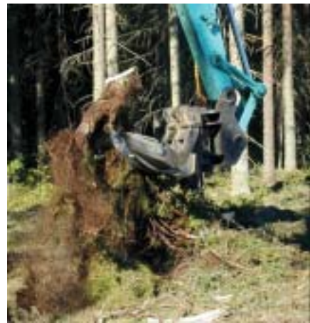
Figura 201: Cabezal especial para destoconado (TEKES, 2003).
