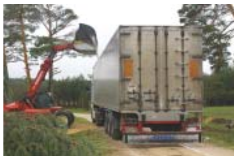
Fig. 39: Cargadora de brazo telescópico alimentando un camión de piso móvil.
