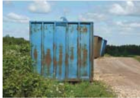
Figura 239: Contenedores de carga lateral.
