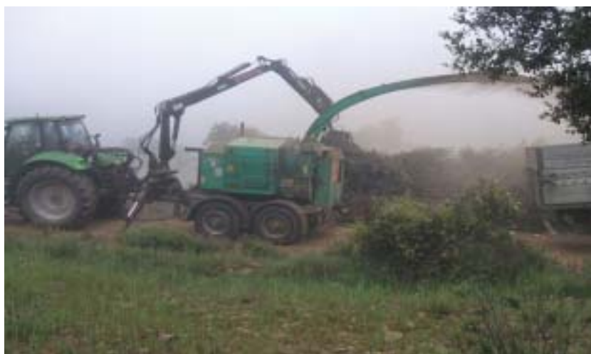
Figura 288: Astilladora móvil remolcada por tractor agrícola descargado la biomasa sobre remolque de camión.
