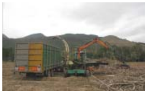
Fig. 112 y113. Acordonado de restos con rastrillo y astillado móvil con astilladora Pezzolato 480/660.
