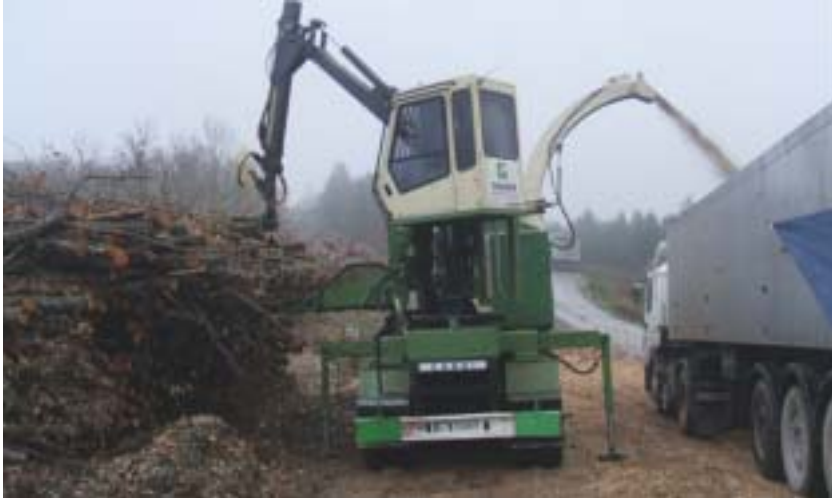
Fig.105: Altura de pila adecuada para la carga en la astilladora.
