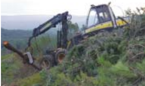
Fig. 6: Procesado mecanizado en corta a hecho, separando madera y residuos para biomasa.
