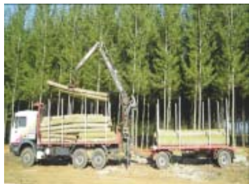
Fig. 116 y 117: Astilladora Erjo y camión rígido con remolque y grúa cargando las trozas (Sistema 3).
