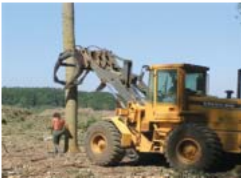
Fig. 34: Cargador frontal auxiliando el apeo de un chopo.
