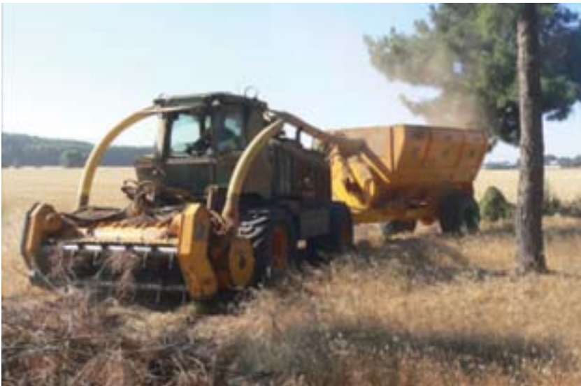
Fig. 50: Trituradora de residuos y cosechadora de matorral con dos ciclones.
