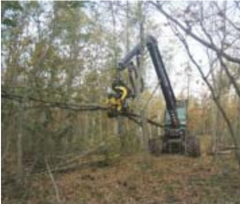
Fig. 81: Cosechadora y cabezal adaptado como acumulador.
