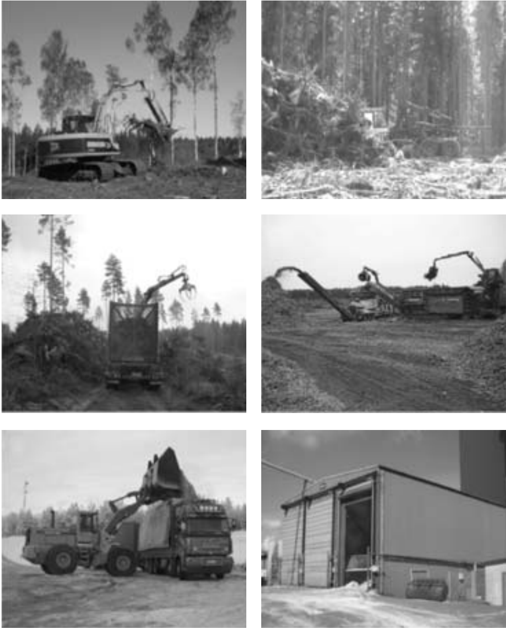
Figura 182: Fases del aprovechamiento de tocones. Fotos tomadas de Sikanen et al., 2005.
