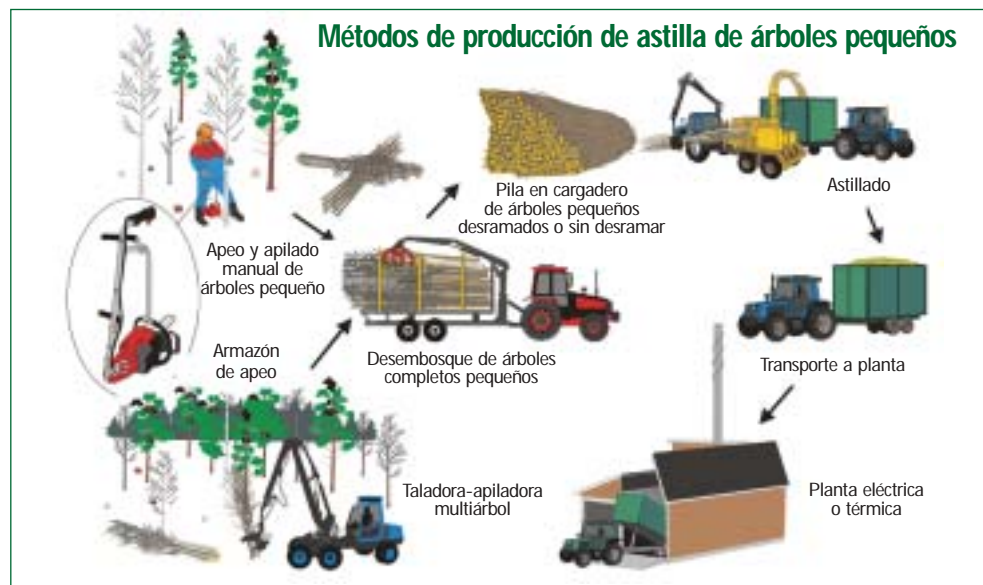
Fig. 145: Esquema de organización del aprovechamiento de biomasa por sistema de árboles completos (Fuente: adaptado de Alakangas – VTT- en Sikanen y Tahvanainen, 2006).
