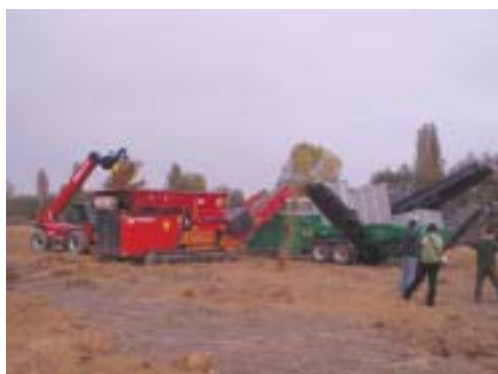
Fig. 25: Pretrituradora y criba en chopera.
