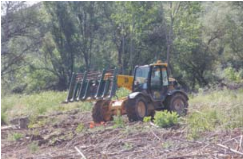
Fig. 40: Apero para reunión de restos (“rastrillo”) acoplable a una cargadora telescópica.
