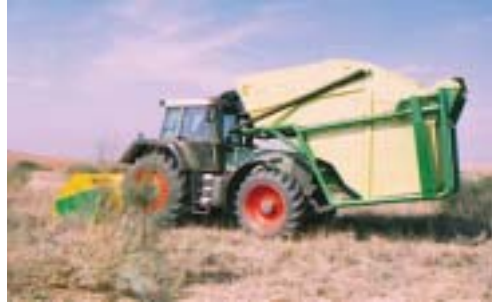
Fig. 49: Apero desbrozador y ciclón de una cosechadora de matorral.
