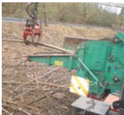
Figura 136: Alimentación de la astilladora.
