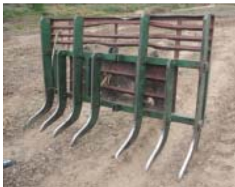
Figuras 126 y 127: Aperos para acordonar los restos: grapa (izquierda) y rastrillo (derecha).
