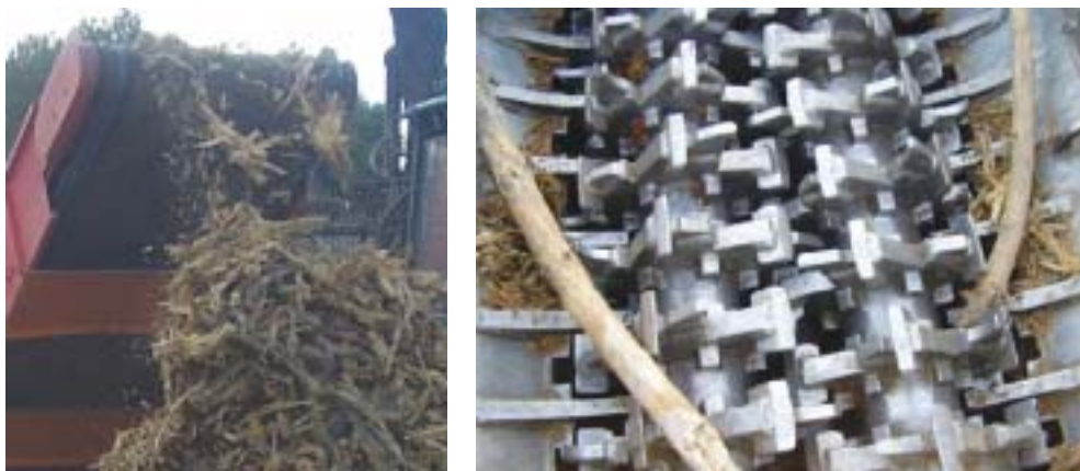
Figuras 195 y 196: Detalles de la cinta transportadora expulsando el material (izda.), y de los tornillos con muelas de la pretrituradora (dcha.).
