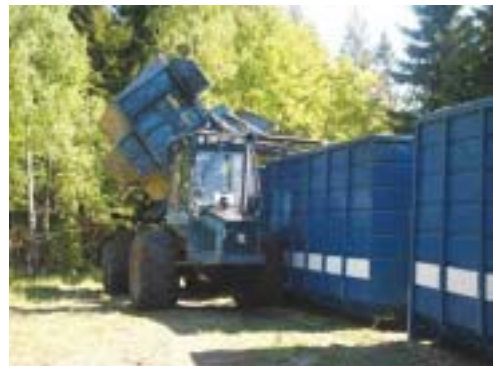
Fig. 9: Basculado de contenedor de monte en lanzadera para la saca de astillas.
