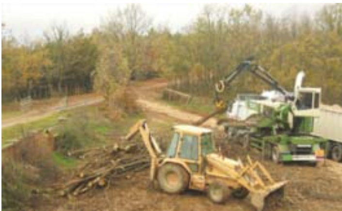
Fig. 33: Pala cargadora con grúa de retroexcavadora adicional.
