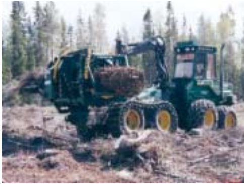
Fig. 10: Empacadora trabajando “en móvil”, con restos de corta a hecho.
