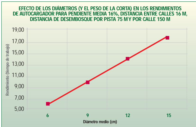
Fig. 101 y 102: Efecto de los diámetros y de la distancia de desembosque en el rendimiento de saca.
