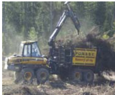
Fig. 168 y 169: Vista lateras de cargador adaptado a la saca de biomasa con laterales abatibles.
