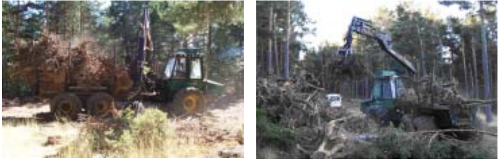
Figuras 187 y 188: Autocargador acopiando tocones
