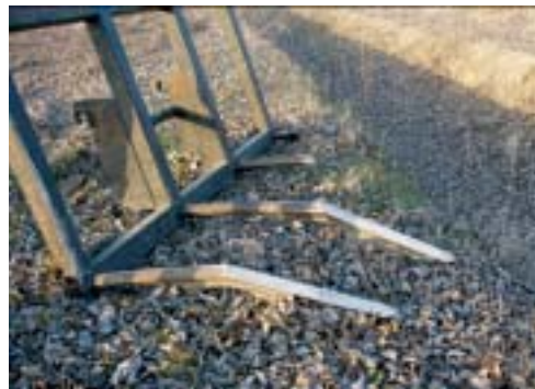
Fig. 35: Peine o rastrillo de reunión de restos acoplable a cargador frontal.
