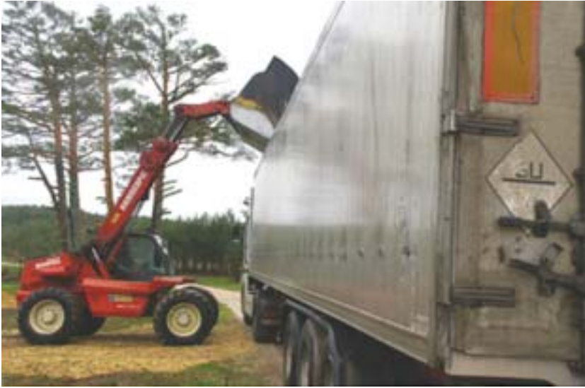
Fig.119: Cargadora de brazo telescópico auxiliar necesaria si se descarga en suelo.
