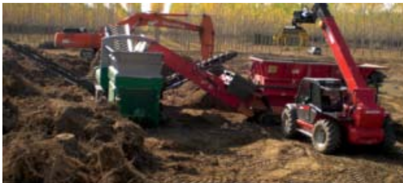
Figura 192: Disposición de las máquinas en el pretriturado de tocones.
