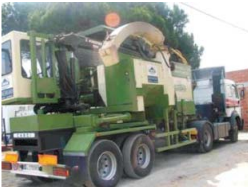
Fig.5: Astilladora sobre camión, que hace astillado fijo de restos de cortas a hecho de pino en Portugal.
