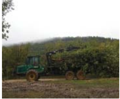
Fig.82: Autocargador extrayendo árboles completos.
