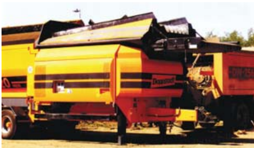
Fig. 29: Criba de discos a la entrada de un trommel.
