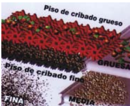
Fig. 28: esquema de doble criba de estrellas.
