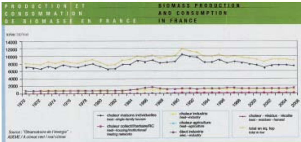
Fig 300: Producción y consumo de biomasa en Francia (tep). La línea amarilla superior es la producción total de energía, la azul corresponde a las calefacciones individuales, las líneas roja y amarilla en la parte inferior representan producciones eléctrica y térmica industriales. La línea rosa inferior, creciente, representa las calefacciones colectivas (district heating). La producción de calor agrícola (azul claro) es prácticamente inapreciable.
