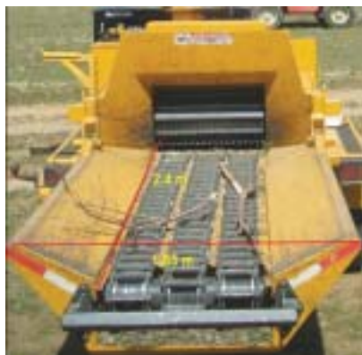
Fig. 175: dimensiones bandeja alimentación.
