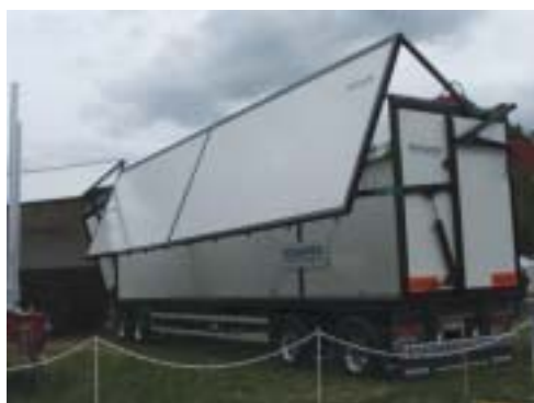
Fig. 64: Remolque de camión de astilla con otro tipo de descarga lateral.
