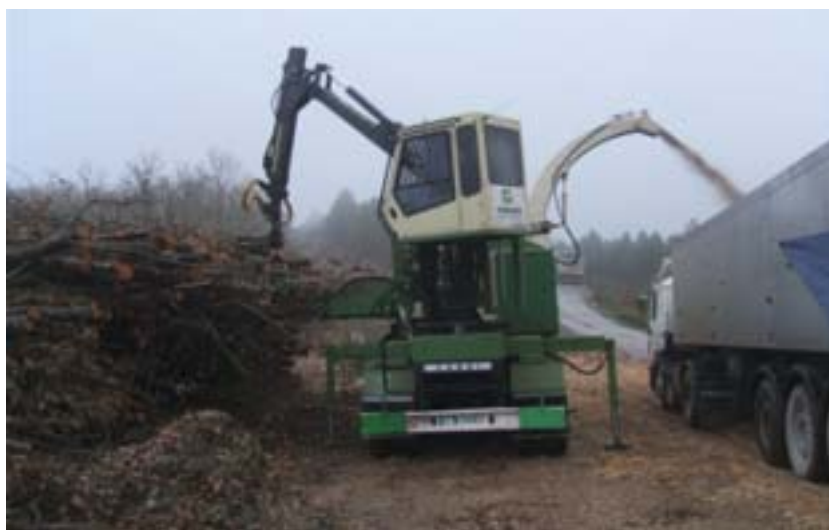
Fig.. 83: Astillado con astilladora en camión sobre “bañera”.
