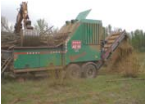
Figuras 140 y 141: Trituradora en Viana de Duero (izquierda) y alimentación de trituradora con una retroexcavadora en Velamazán (derecha).
