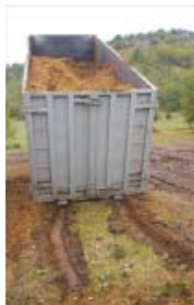
Fig. 71: Problemas en la carga de contenedores en tiempo húmedo.
