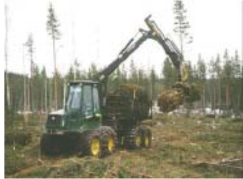
Fig. 11: Autocargador extrayendo pacas de forma similar a trozas de madera.
