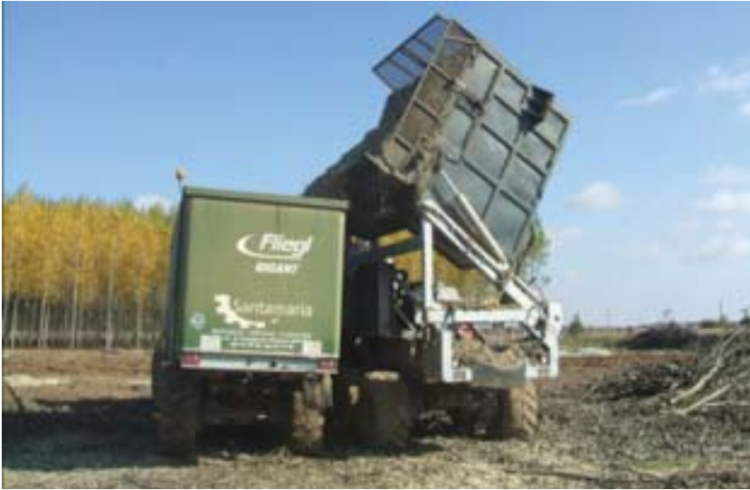
Fig. 121: Astilladora volcando su contenido sobre tractor con remolque.
