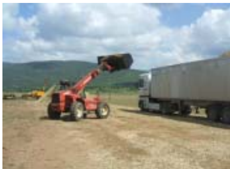
Fig.162: Cargador telescópico ligero cargando un camión de piso móvil.
