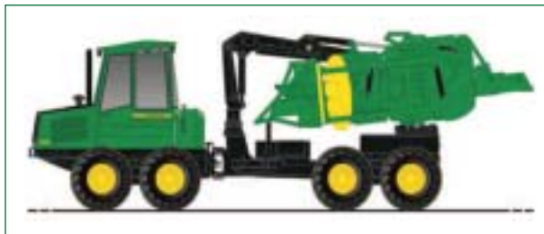
Fig. 178: Esquema de una empacadora Fiberpac montada sobre autocargador.
