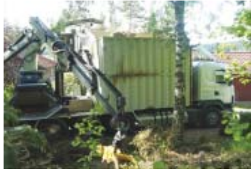
Fig. 67: Grúa y Alimentación de una astilladora integrada en camión.
