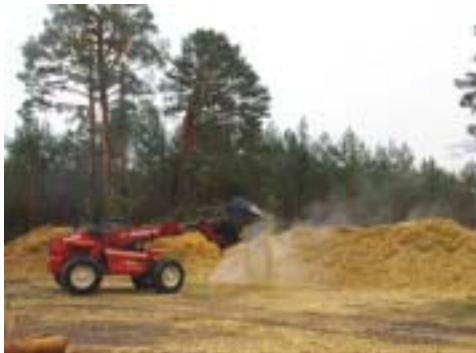
Fig. 91: Pala auxiliar necesaria si se descarga en suelo.
