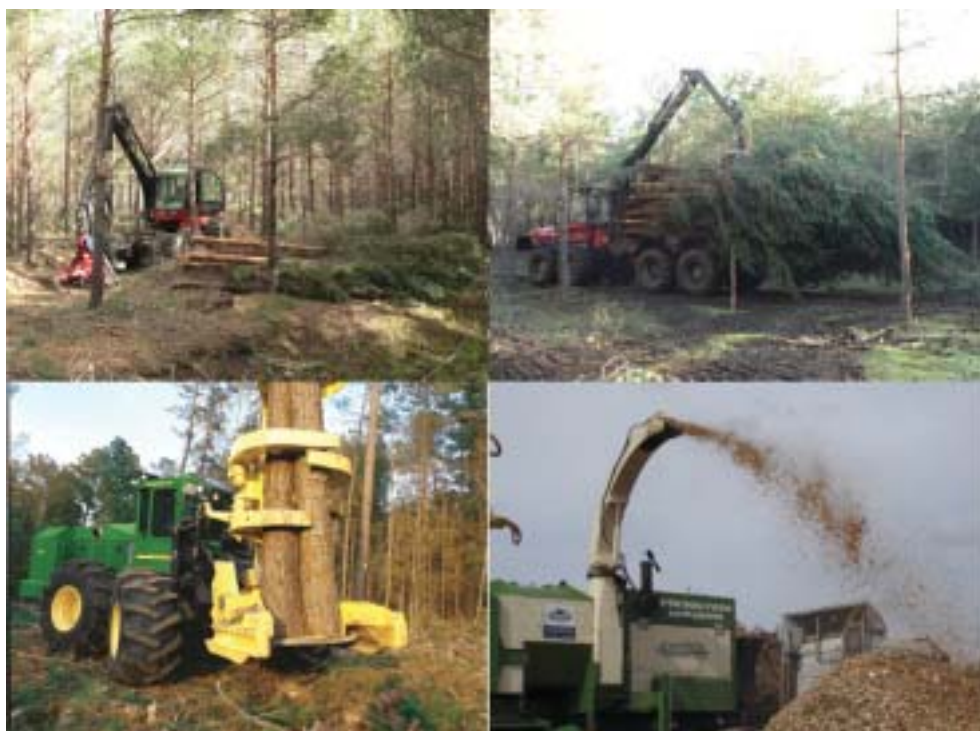
Figura 307: Ejemplos de maquinaria asociada a los sistemas integrados de producción de astilla siguiendo al aprovechamiento de árboles completos
