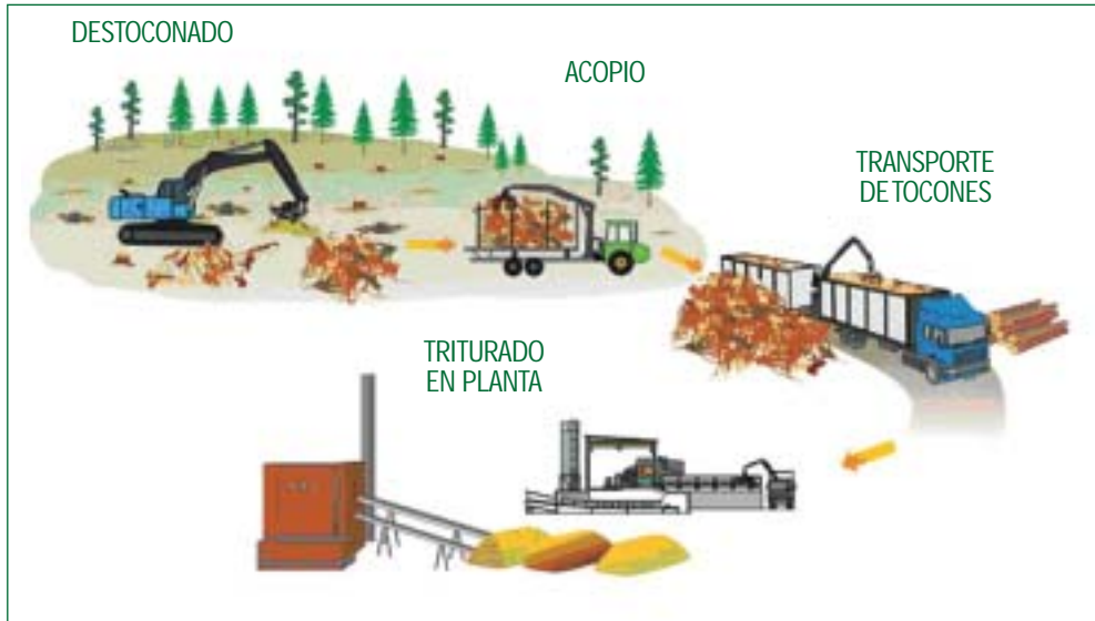
Figura 181: Método de producción del aprovechamiento de los tocones en los países escandinavos (Fuente: adaptado de Hakkila, 2004).
