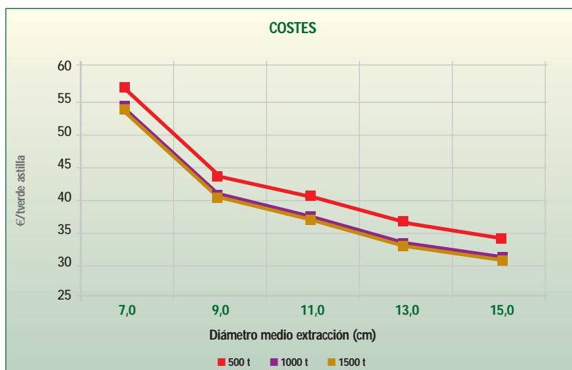
Fig. 180: Evolución del coste según diámetro medio y volumen de biomasa total.
