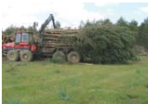
Fig. 148: Autocargador Valmet transportando árboles completos.
