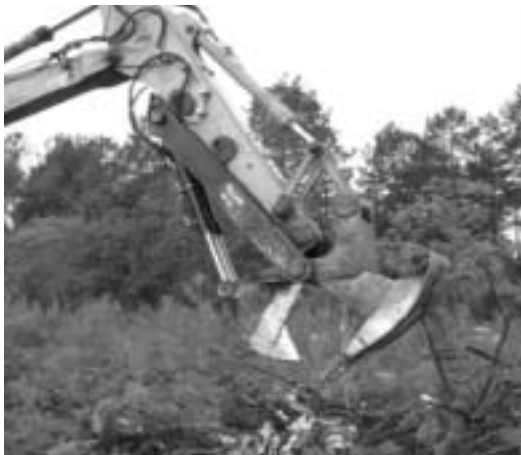
Figura 200: Detalle de una grapa Pallari KH 160 con una cizalla de corte vertical (Fraise, 2007).
