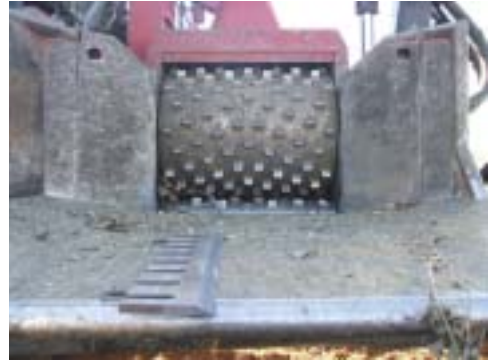
Figura 250: Mesa de alimentación y cuchilla.
