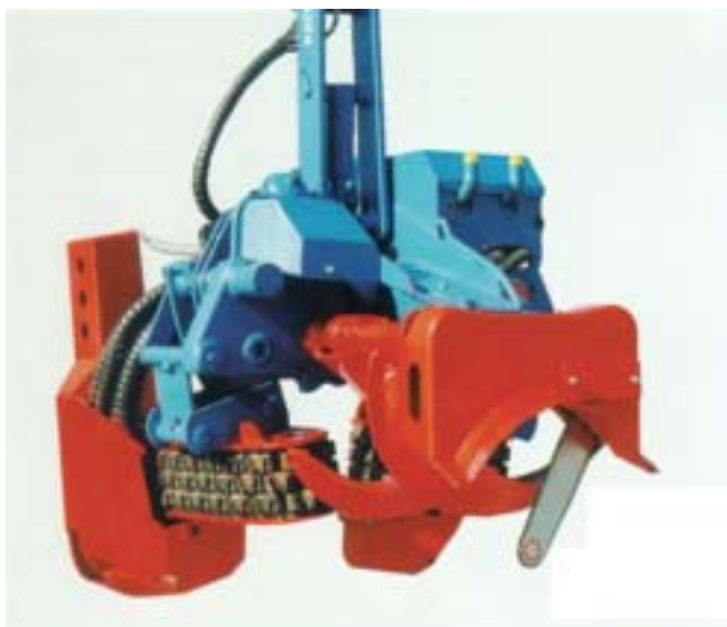
Fig. 41: Cabezal cosechador con motosierra adicional para despunte.
