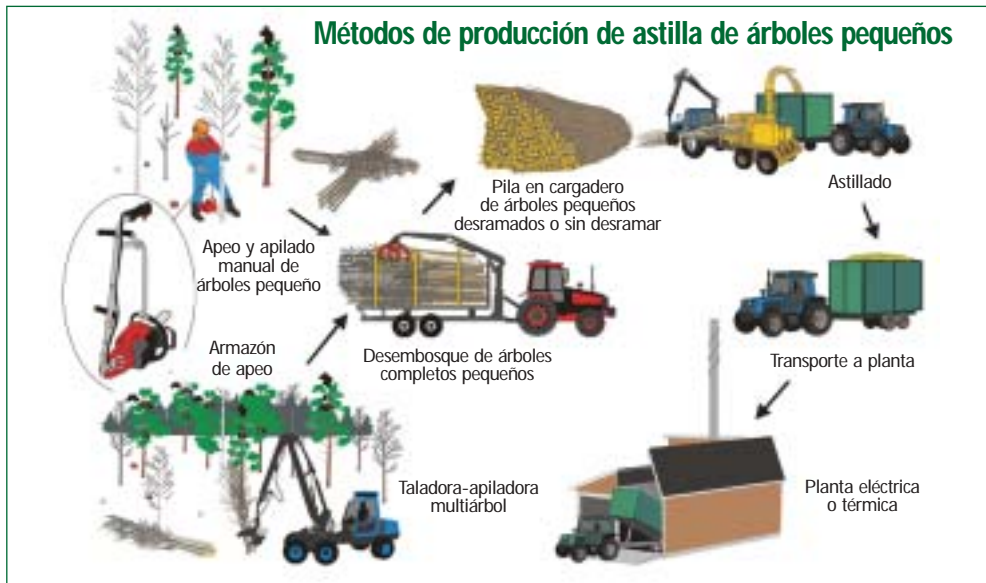
Fig. 74: Métodos de producción de astillas en los países escandinavos (Fuente; adaptado de Alakangas-VTT- en Sikanen y Tahvanianen, 2006).
