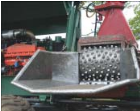
Fig. 22: Mesa alimentadora de astilladora móvil. Fig. 23: Astilladora móvil con contenedor basculante.
