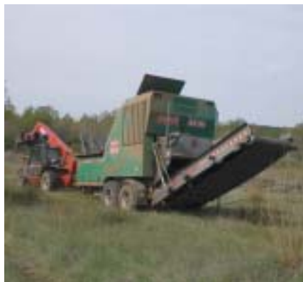
Figura 134. Trituradora remolcada por la cargadora telescópica Manitou.
