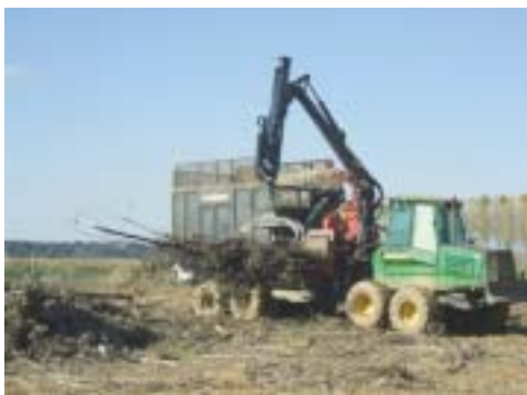
Fig. 116 y 117: Astilladora Erjo y camión rígido con remolque y grúa cargando las trozas (Sistema 3).
