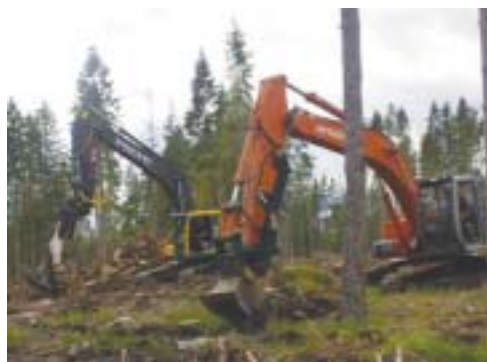
Fig. 12: Retroexcavadoras extrayendo tocones tras corta a hecho de Picea .
