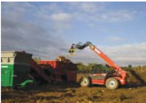
Figura 211: Trituradora alimentada con cargadora de brazo telescópico (Sistema 2).
