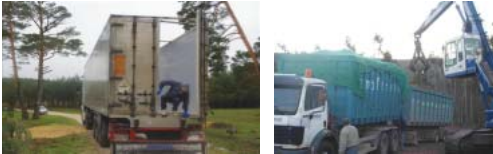
Fig. 93 y 94: Piso móvil y protección con lona.
