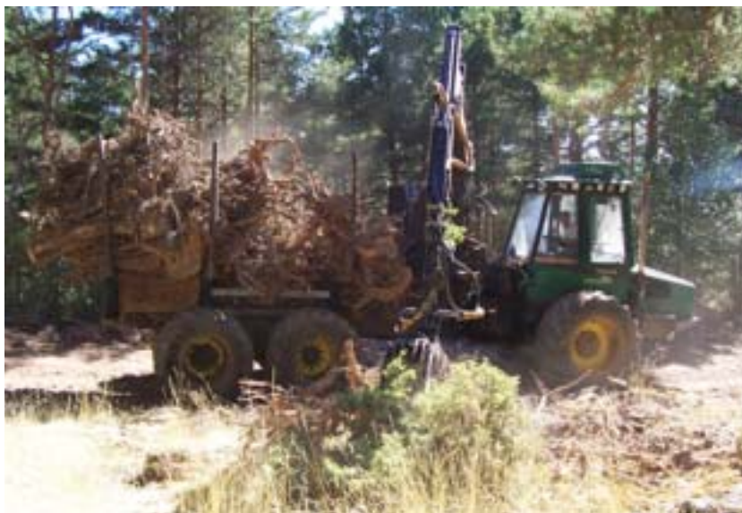
Figura 207: Autocargador recogiendo tocones en la pista forestal (Sistema 1).
