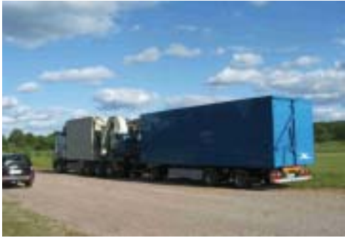
Fig. 66: camión sueco con remolque y astilladora integrada.
