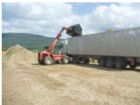
Fig. 151: Cargadora ligera de brazo telescópico cargando astillas en camión de piso móvil.
