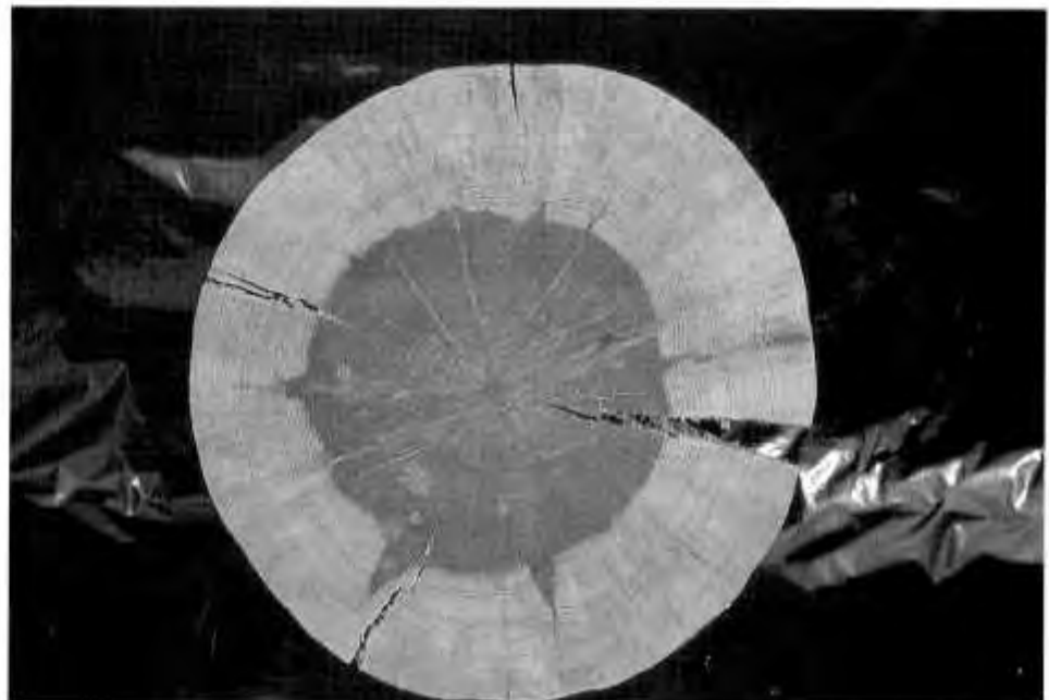
La teu o duramen resinoso del pino canario es una madera de cualidades excepcionales para usos en los que se precise estabilidad y durabilidad. (Foto: J. Climent.)
