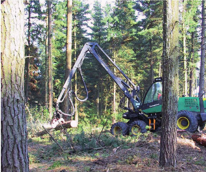
Figura 3.28. Cosechadora forestal con cabezal único de apeo y procesado en punta de grúa
