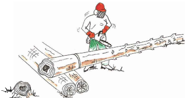
Figura 2.113. Saneado de la madera en el fuste apeado
