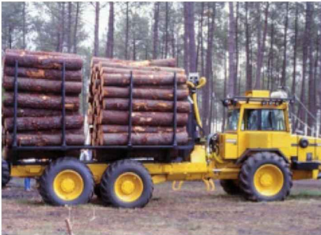
Figura 4.63. Diseño de la caja o remolque para apilado longitudinal, propio de madera larga
