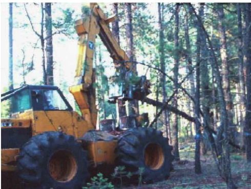
Figura 3.29. Cosechadora con cabezal de apeo en punta de grúa y procesado en plataforma
