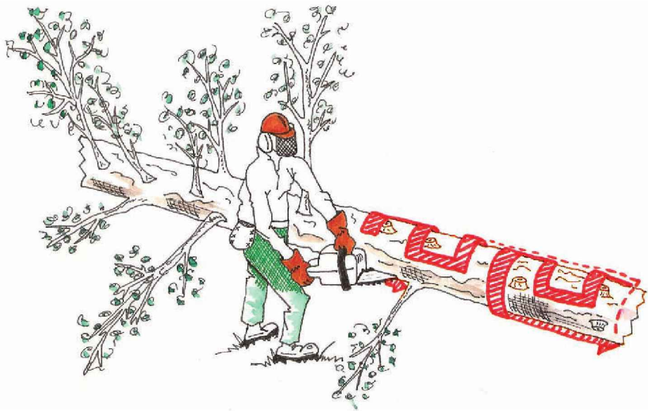
Figura 2.96. Técnica de desramado para árboles de ramas delgadas distribuidas simétricamente según el método de palanca
