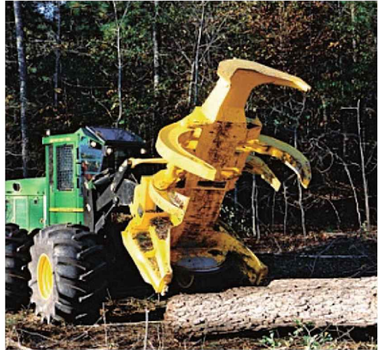
Figura 3.30. Cabezal multitalador pesado
