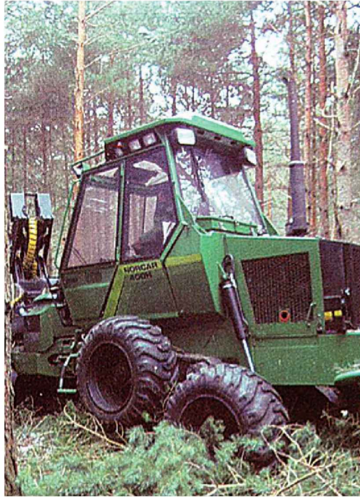
Figura 4.37. Bogie de accionamiento forzado
