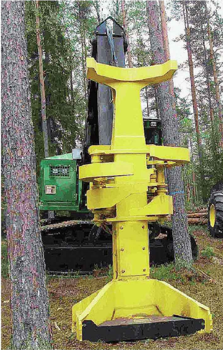
Figura 3.8. Cosechadora de cadenas pesada
