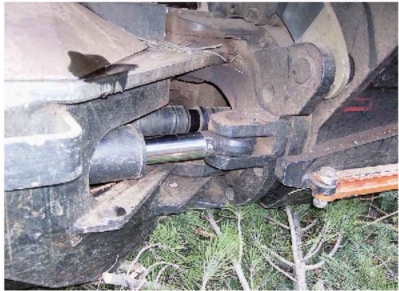
Figura 4.15. Articulación del chasis del tractor (Fotografía: E. Tolosana)
