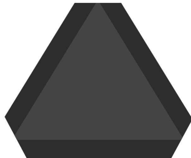
Figura 4.68. Señalización de vehículo lento
