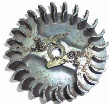
Figura 2.6. Aletas del volante del sistema de encendido
