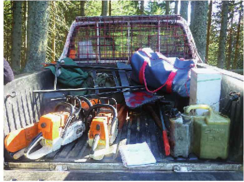
Figura 2.137. Las furgonetas tipo "pick-up" permiten el transporte de motosierras en habitáculo separado de los operarios
