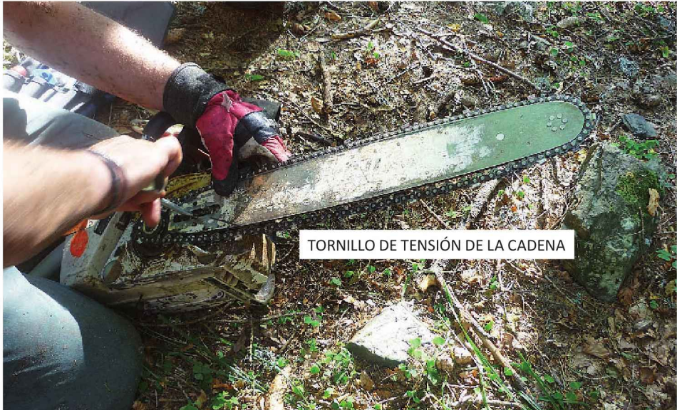
Figura 2.12. Colocación de la espada
