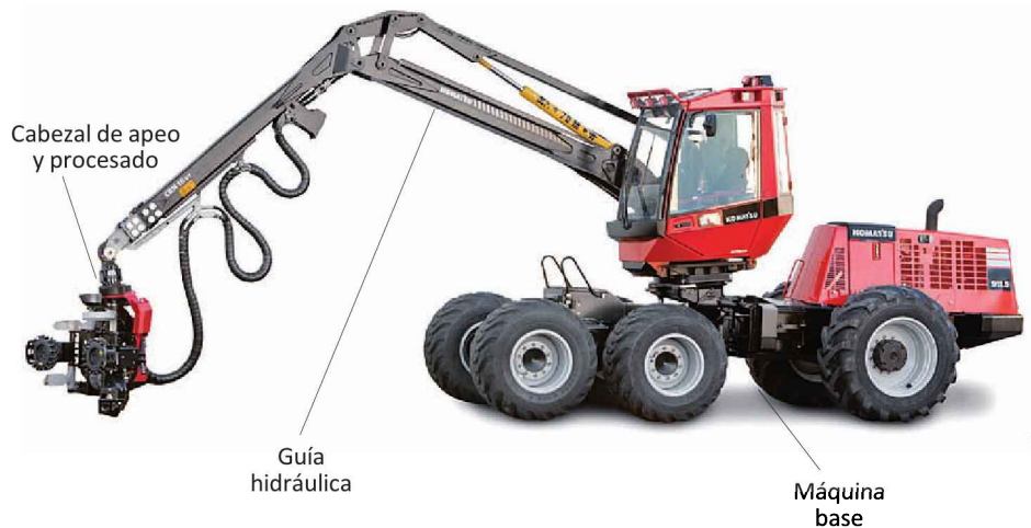
Figura 3.1. Partes de una cosechadora forestal
