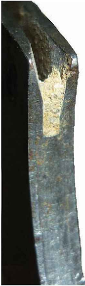
Figura 2.157. Detalle de una ranura de espada obturada con barro
