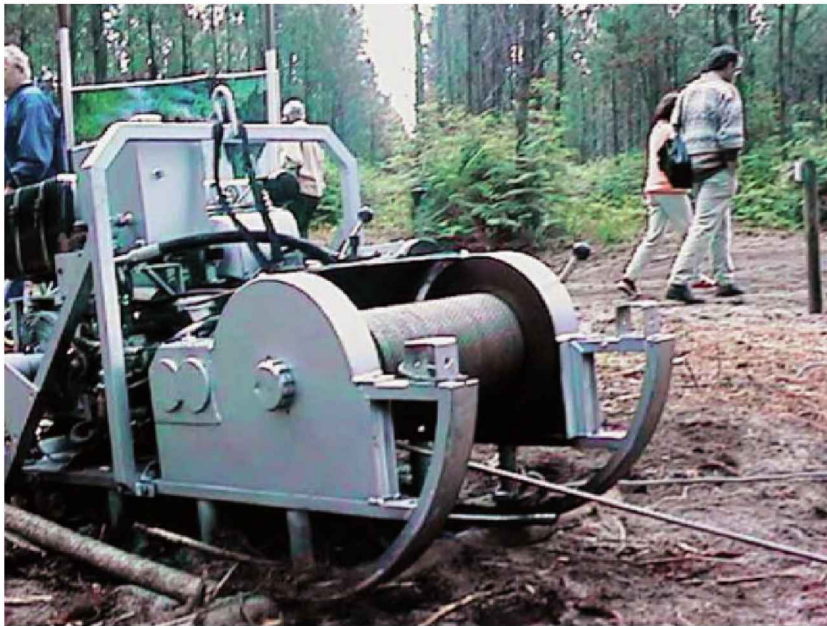
Figura 4.72. Grupos motrices: motriz autoportante, tipo trineo
