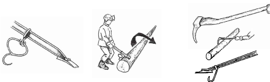
Figura 2.75. Uso de la palanca como giratroncos
