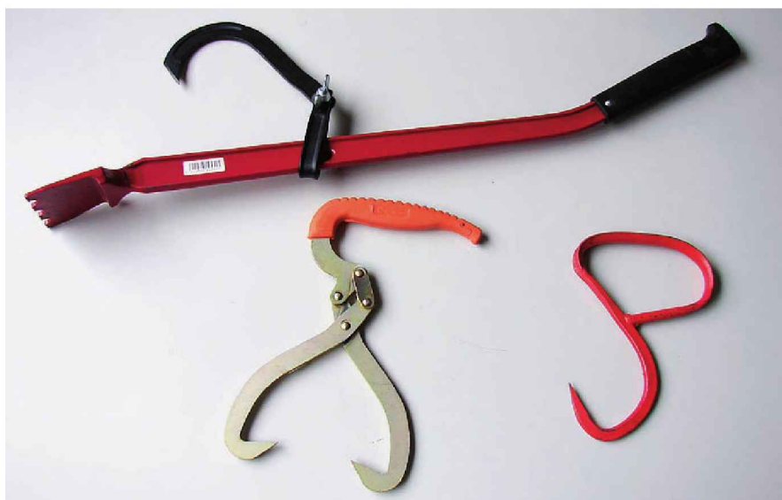
Figura 2.133. Palanca de derribo con gancho giratroncos, pinzas y gancho de maderero
