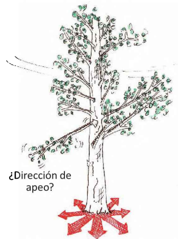
Figura 2.47. Factores a observar antes del apeo (rama lateral, viento, forma de copa)
