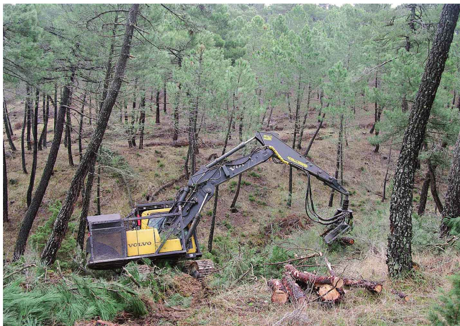
Figura 3.57. Corta selectiva mecanizada de árboles torcidos en una plantación de pino rodeno
