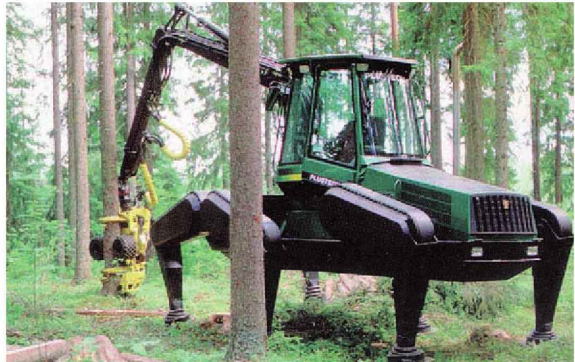
Figura 3.10. Prototipo de cosechadora con seis patas en vez de neumáticos u orugas
