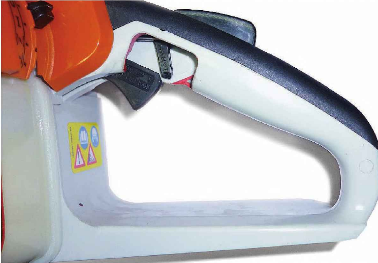
Figura 2.21. Doble accionamiento del acelerador
