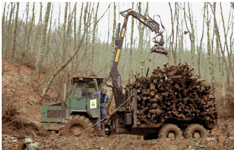
Figura 4.61. Grúa hidráulica incorporada al semichasis trasero de un autocargador
