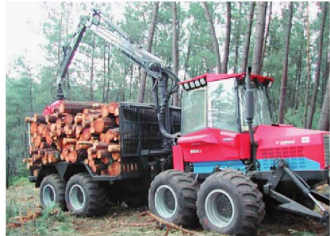
Figura 4.64. Diseño de la caja o remolque para apilado transversal, propio de madera corta
