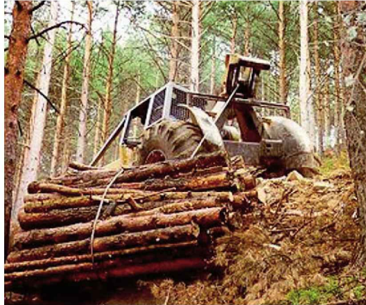
Figura 2.127. Skidder cableando desde pista
