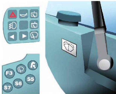
Figura 4.32. Interruptores en cuadro de mandos de una cabina
