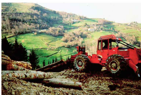
Figura 4.54. Skidder actuando por cableo cerrado desde pista en montes de gran escabrosidad o buena red de pistas
