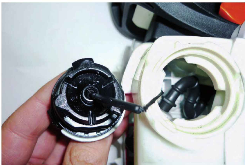
Figura 2.155. Detalle del tapón del depósito combustible con cordón antipérdida
