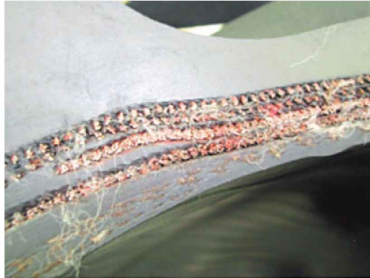
Figura 4.39. Estructura de un neumático forestal
