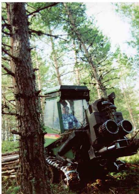
Figura 3.12. Cosechadora con cabezal de corte por cuchillas. En esta máquina, además, el cabezal no va montado sobre una grúa sino sobre brazos hidráulicos
