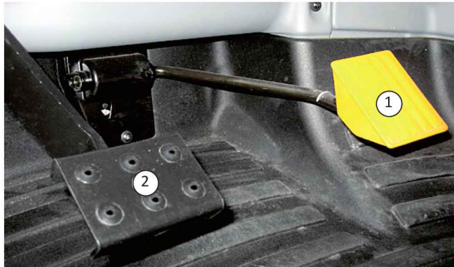
Figura 4.25. Pedal de freno (2) y pedal de acelerador (1) en cabina de tractor forestal (Fotografía cortesía de John Deere)
