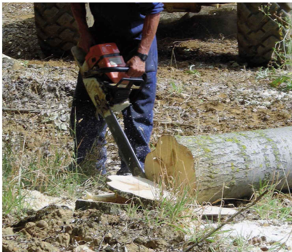
Figura 2.105. Eliminación de la rodaja basal para la adecuada medición de trozas destinadas a chapa
