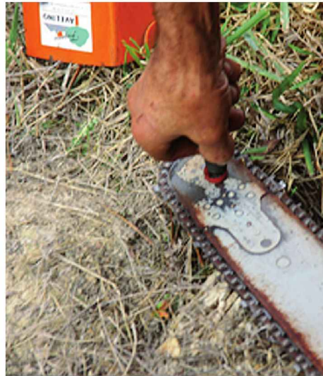
Figura 2.150. Engrase y limpieza del piñón de la punta de la espada
