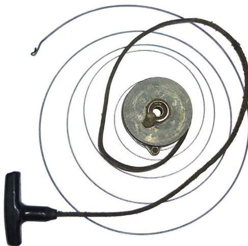
Figura 2.161. Sistema de arranque con la cuerda muy deteriorada
