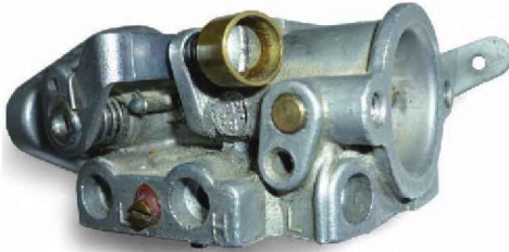
Figura 2.163. Detalle del carburador
