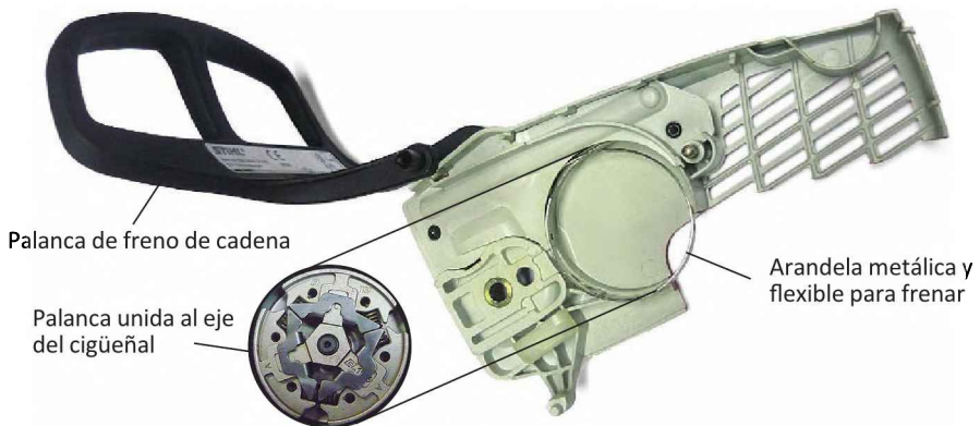
Figura 2.20. Esquema del freno de cadena
