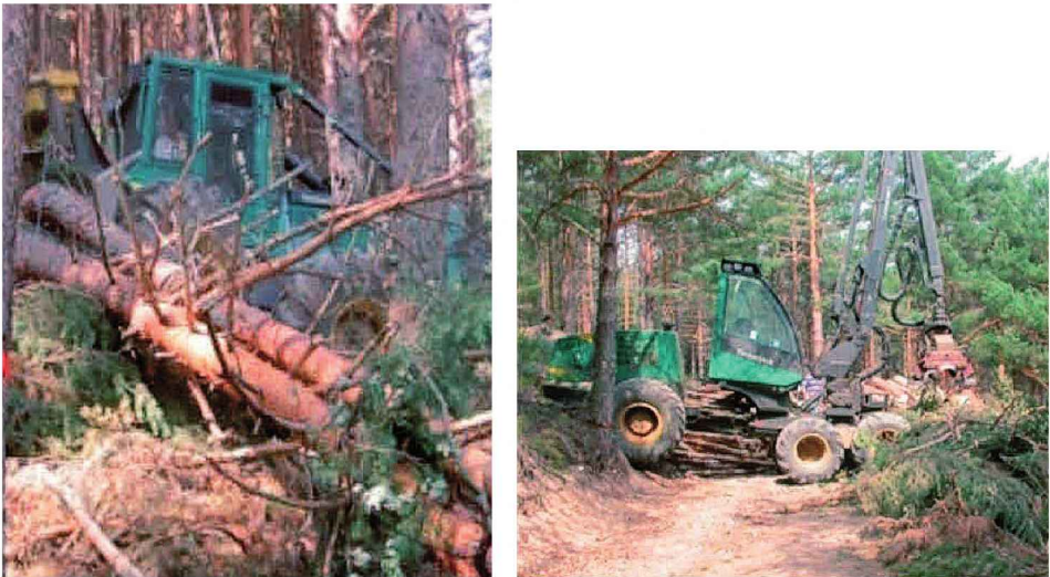
Figuras 3.70 y 3.71. Cableo de pinos enteros hasta pista y uso de cosechadoras para su procesado en pista
