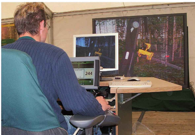
Figura 3.49. Simulador para el entrenamiento de maquinistas de cosechadora forestal
